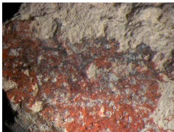
Campione 6. Stereomicroscopio, luce riflessa, ingrandimento rispettivamente di circa 10 x Aspetto di una porzione del campione prelevato. Sopra l'intonaco (I), di colore avorio giallino, la pellicola pittorica di colore rosso arancio (P).
