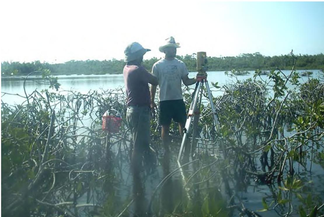
**Figura 11. La Estación Total en la cota de referencia principal.**
