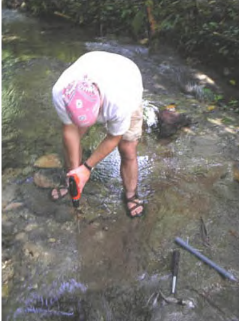
Figura 11. Kirk French taladrando en el lecho del arroyo por PT-1 con una broca de taladro extendida.
