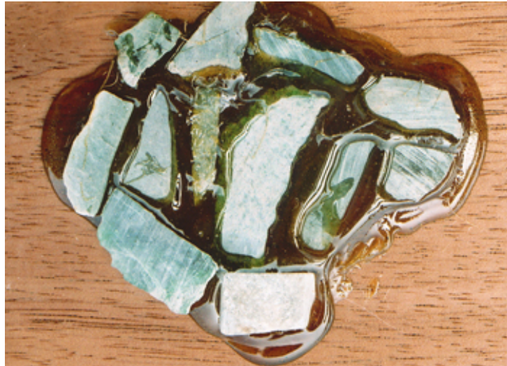
Figura 16. Jadeíta fijada a madera de Cedrela odorata con un adhesivo de copal y cera de abeja.
