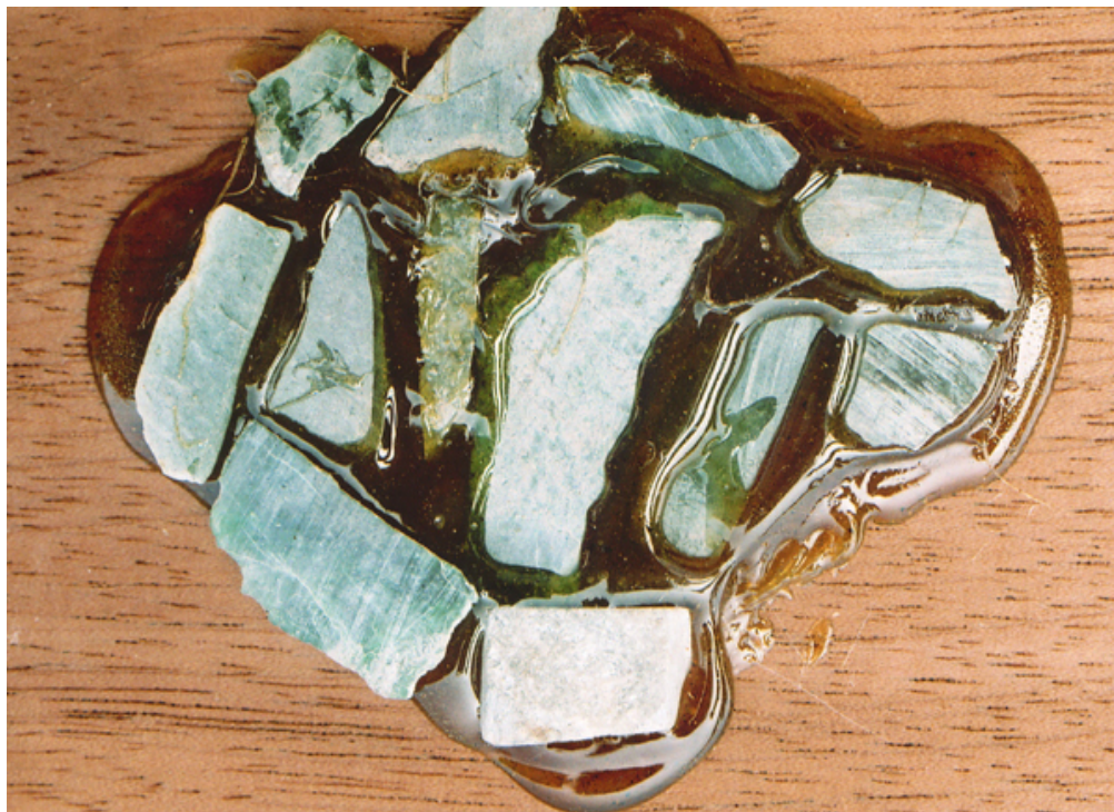
Figura 16. Jadeíta fijada a madera de Cedrela odorata con un adhesivo de copal y cera de abejas.
