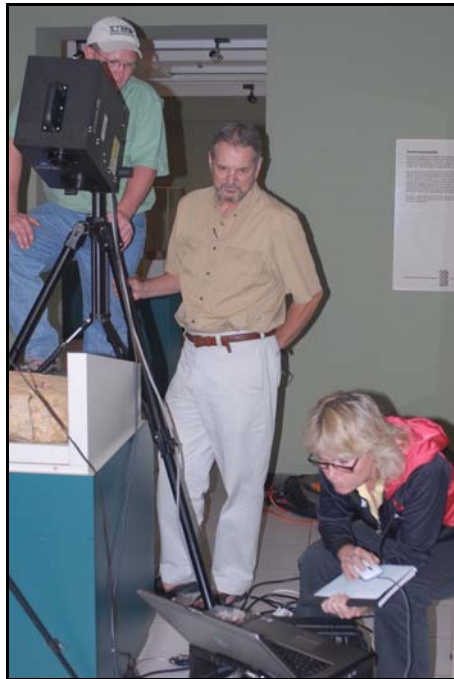
Figura 1. El investigador estudiante, Bart McLeod, junto con los Investigadores Principales Travis Doering y Lori Collins, aparecen aquí usando un escáner láser para tres dimensiones en un altar que está siendo conservado en el Museo del Popol Vuh.
